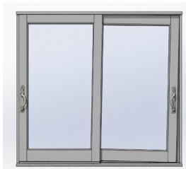
INCORRECTO: LOS MONTANTES DE LOS PANELES Y LAS JAMBAS DEL MARCO ESTÁN DESALINEADOS.
